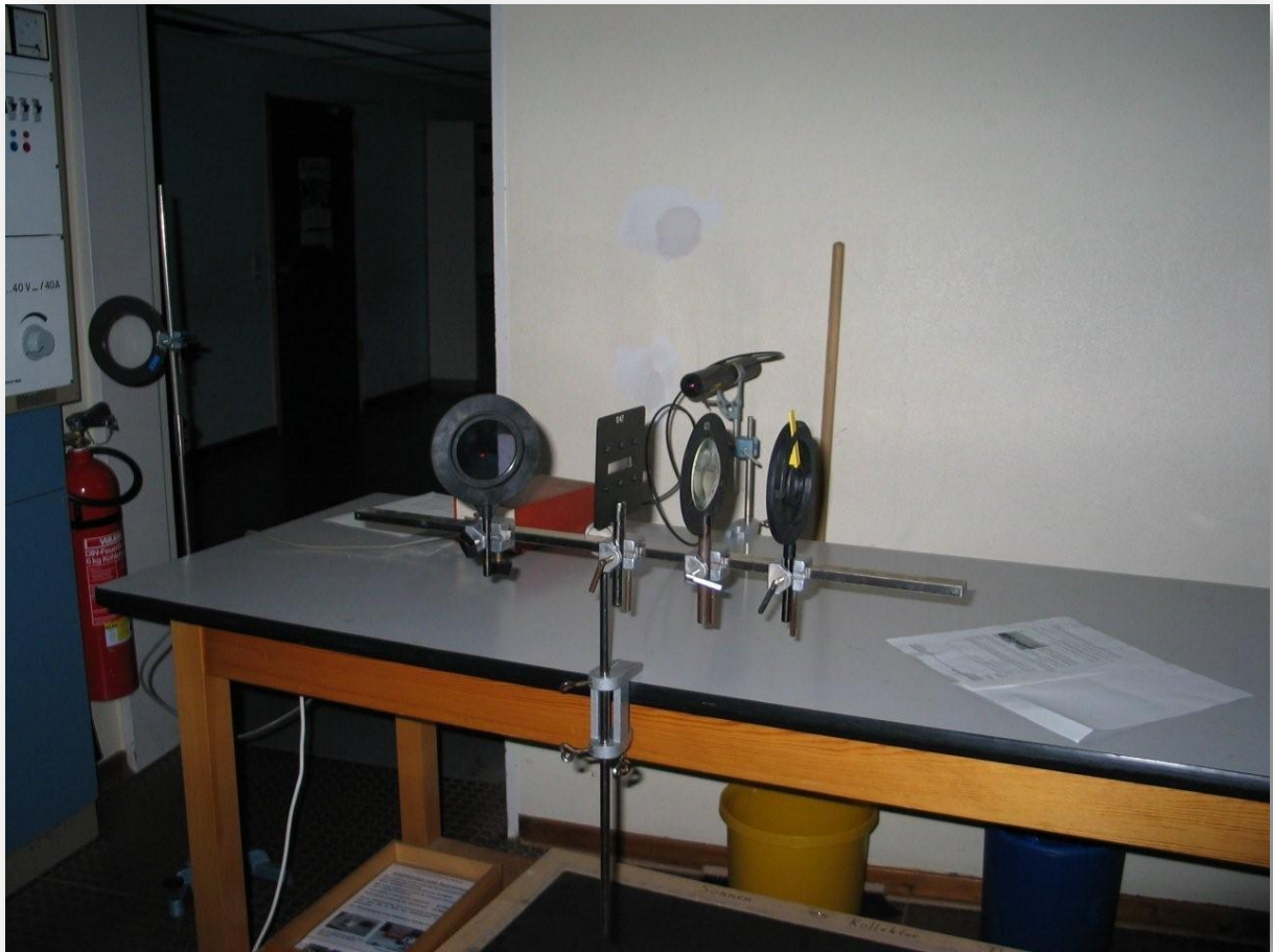
Beobachtungsapparatur (von links): Strahlteiler, Skala, Lupe, Irisblende. Die Blende ist beim Versuch mit Laserlicht nicht unbedingt notwendig. Hinten links die Linse.
