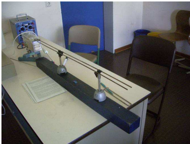
Lecherleitung mit einem offenen Ende
