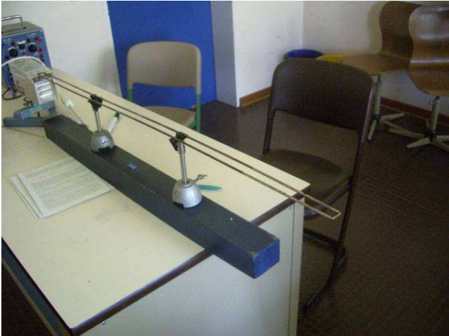
Lecherleitung mit einem geschlossenen Ende
