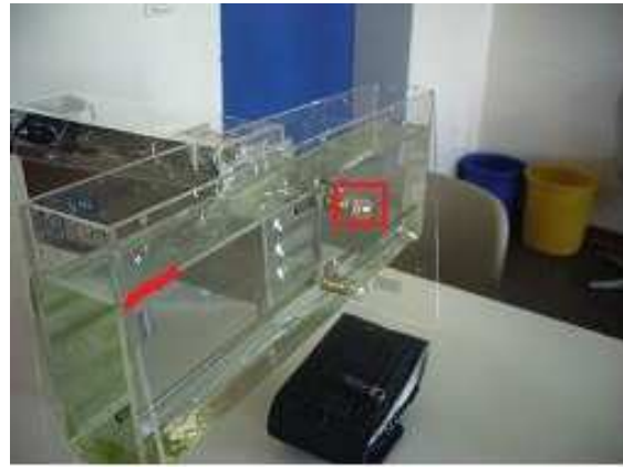
Lämpchen D2 leuchtet. Destilliertes Wasser befindet sich über D2
